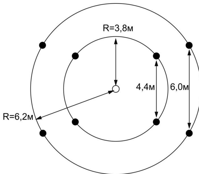
3. Упражнение «Габариты» - две пары ограничителей в виде стоек с консолями, установленных горизонтальной частью (консолями) на высоте наибольшей ширины автомобиля. Участник должен проехать «габариты» не задев ограничителей.
